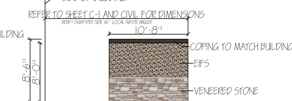
TRASH ENCLOSURE SCALE: 1/8" = 1'-0" (BACK)
