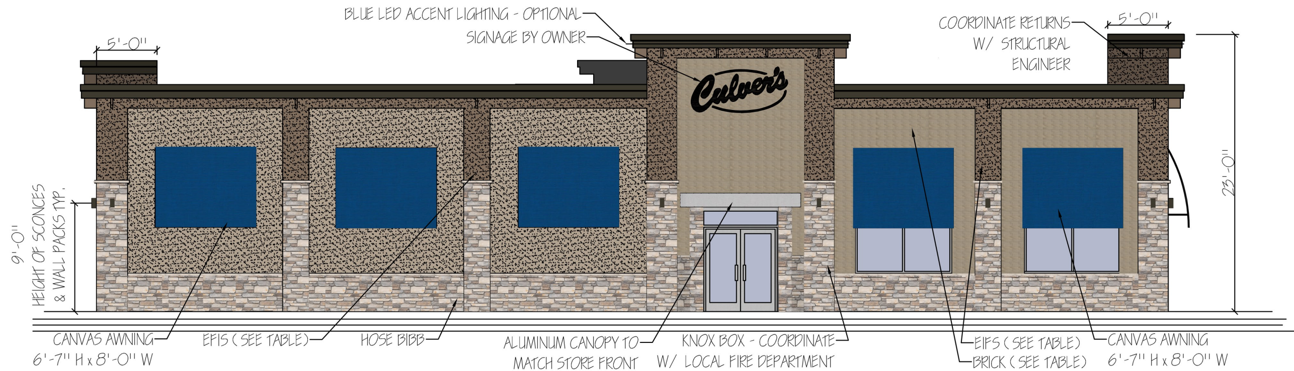
1 EAST SIDE ELEVATION A-3 SCALE: 1/8" = 1'-0"
